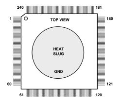
THE 240-LEAD PACKAGE CONTAINS A COPPER HEAT SLUG FLUSH WITH ITS TOP SURFACE. THE SLUG IS INTERNALLY CONNECTED TO GROUND.
