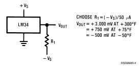
FIGURE 2. Full-Range Fahrenheit Temperature Sensor
